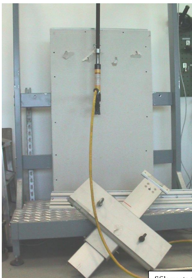
Sfilamento tasselli e rottura cartongesso.
